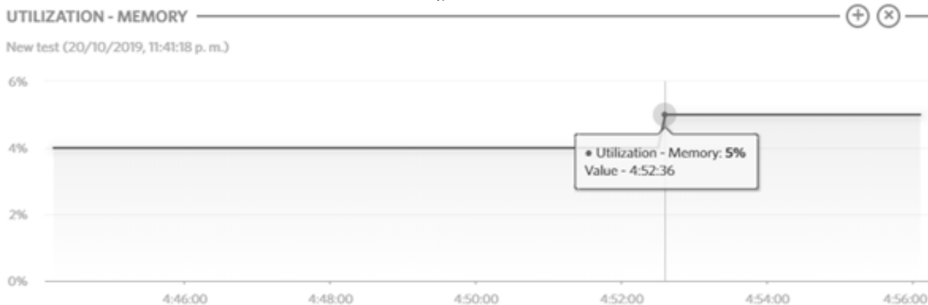
FIGURA 8. Resultado del porcentaje de uso de la memoria durante las pruebas de stress al servidor de pruebas de la Universidad Santiago de Cali.
